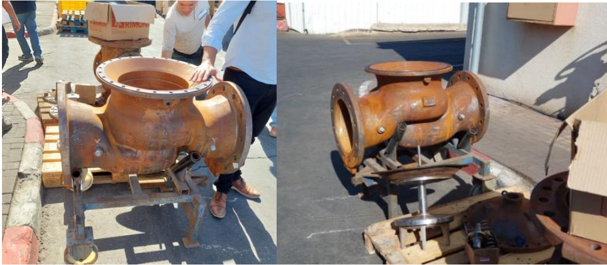
Figura 26. Válvulas en estado crudo importadas desde China luego de la fundición
