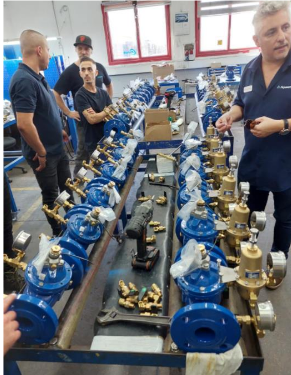
Figura 29. Proceso de ensamblaje de las válvulas de control hidráulico
