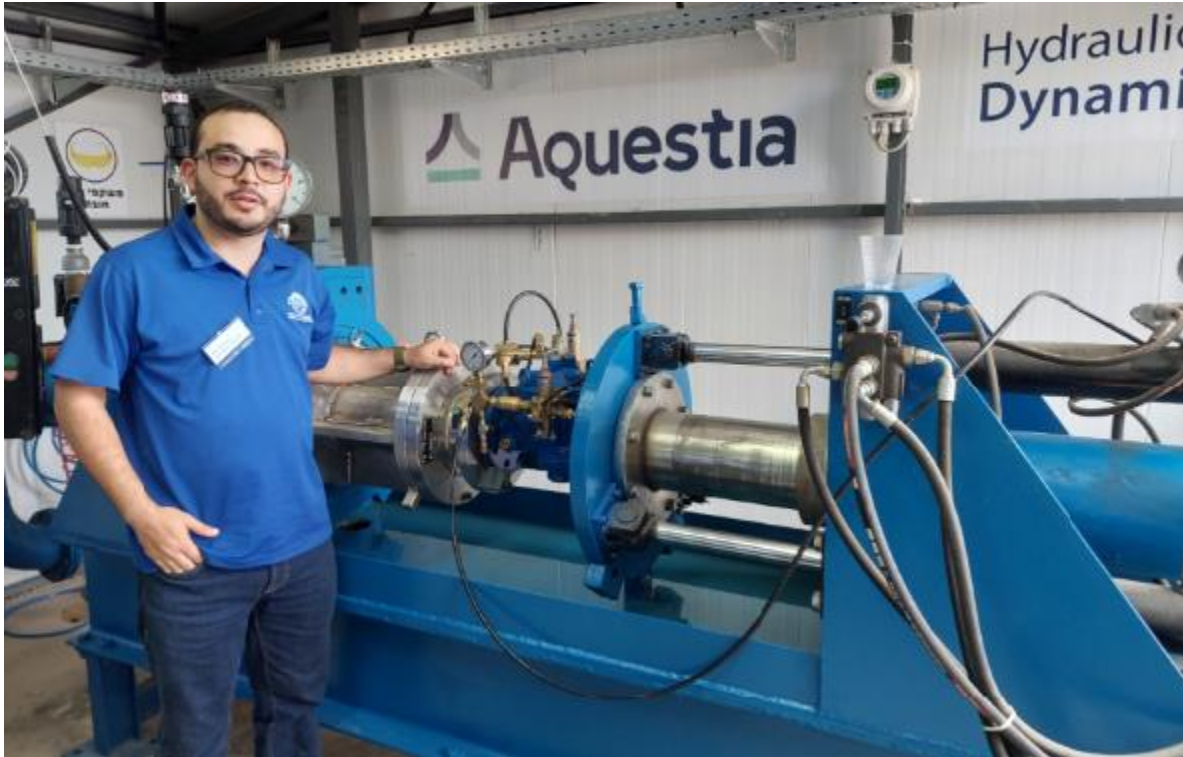
Figura 10. Ensayo a la válvula anticipadora de golpe de ariete
