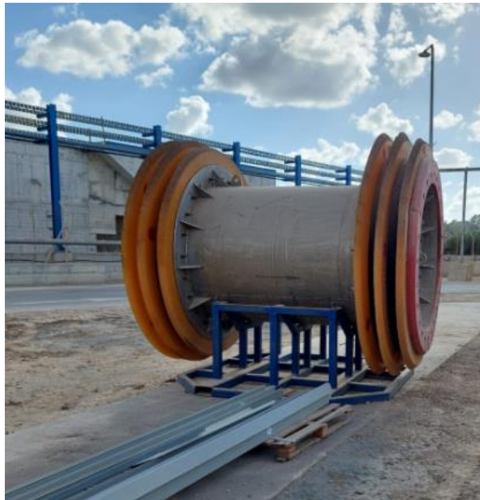
Figura 22. Pieza utilizada para la limpieza de la tubería que trae el agua desde el mar
