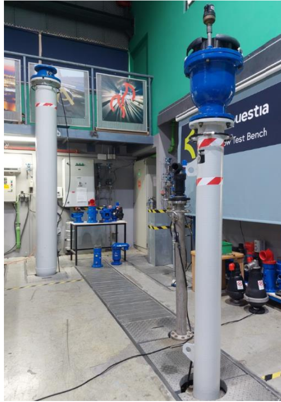
Figura 12. Banco de pruebas de las válvulas de aire
